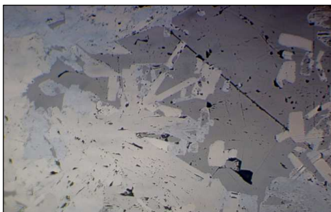
Fotomicrografía de cristales prismáticos de sanmartinita (castaño rojizo) asociados a scheelita (celeste grisáceo). Luz reflejada, nicoles paralelos. Ancho del campo 0,8 mm. Foto: N. Maffini.
