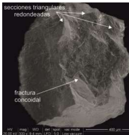
Figura 4: Fotografía obtenida mediante microscopio electrónico de barrido de un cristal de turmalina.
